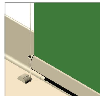
Morsetto a pavimento (a richiesta per guida in perlon Ø 1,2 mm.)
