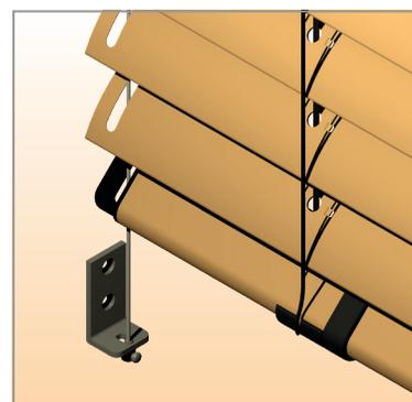
Guida in acciaio rivestito Ø 2,5 mm
